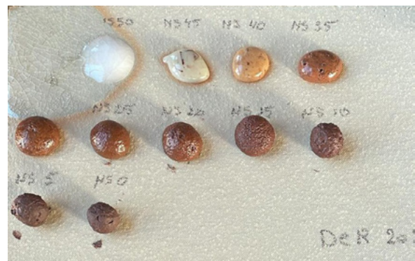
Éprouvettes de tests de température de fusion de différentes argiles.
