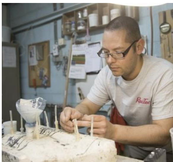
Les moules sont réalisés en silicone, dans un coffrage de plâtre.
